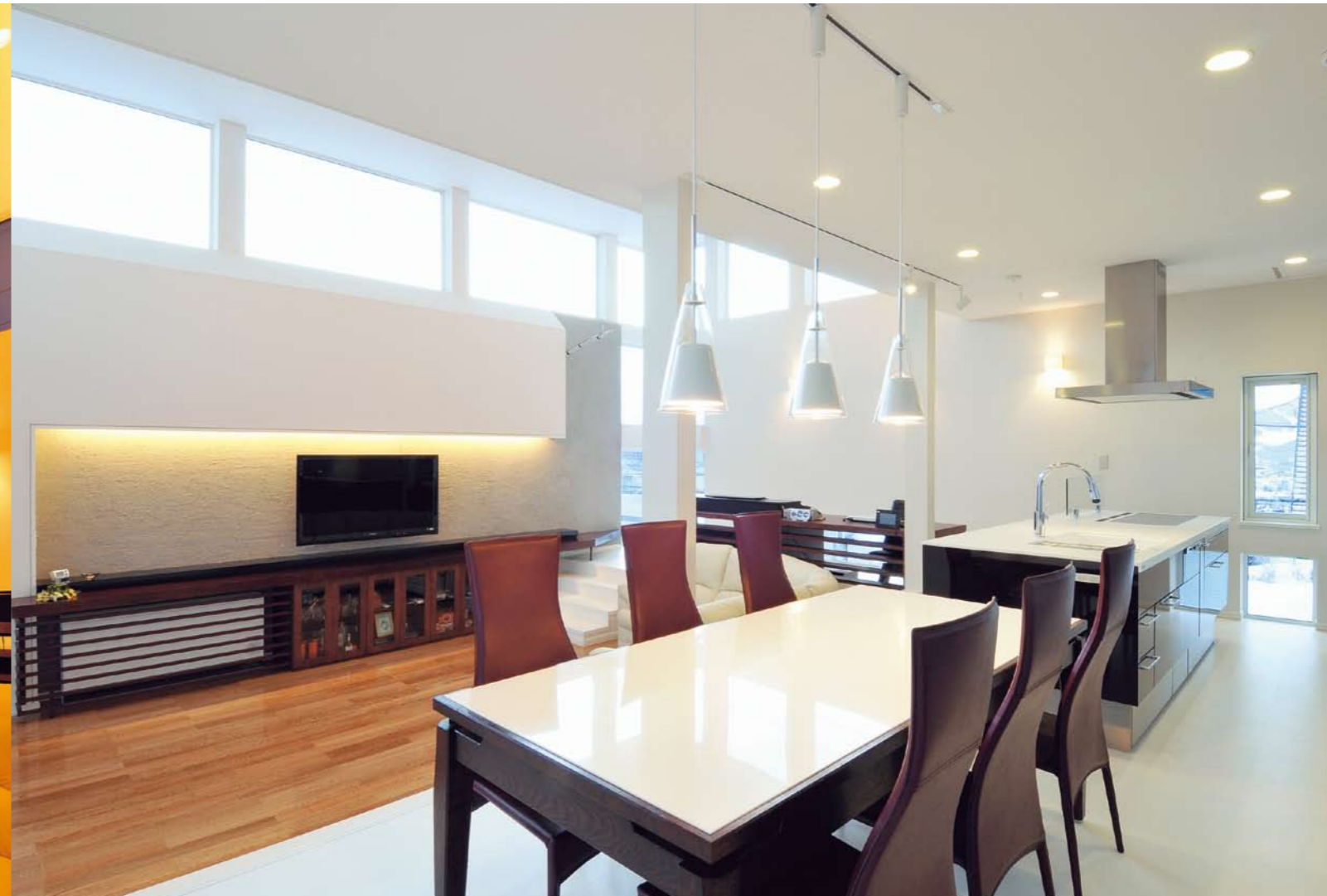
ダイニング・キッチンからリビング方向。道路に面した角には、室内に景色を取り込むためのコーナー窓を準備。外部からの視線が気になる壁面はハイサイドライトを設置することで存分に光を取り込んでいる
